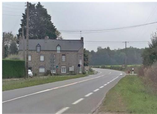
Un bâti proche, qui masque la visibilité au débouché de la voie communale, et un carrefour en sortie de courbe sont les principales sources de l'accidentologie
